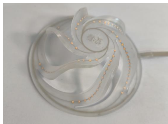
Slika 5: Končna oblika kirigami LED svetilke
